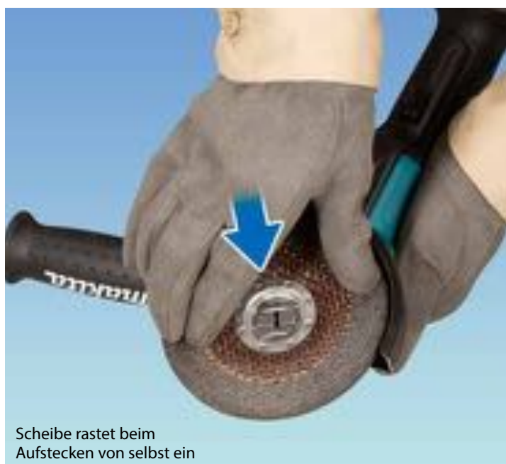
Einfaches Lösen der Scheibe per Hebel
